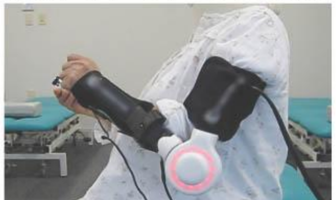
患者さんの意思に従った動作をサポートする装着型サイボグ。繰り返すことで正しい動作が脳神経系に定着し、外した後の動作も改善が期待できます。（園田康男先生提供）
